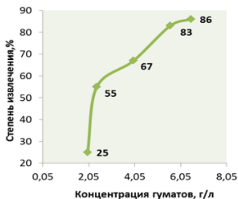
Рис. 1 – Зависимость степени извлечения ионов свинца от количества гуматов для сухого внесения (исходная концентрации свинца - 0,52 г/л, время сорбции 1 час, рН=6, сорбция при комнатной температуре).
